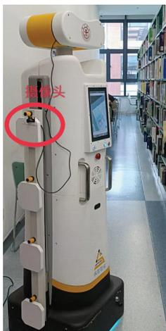
图5 配置摄像头的盘点机器人
